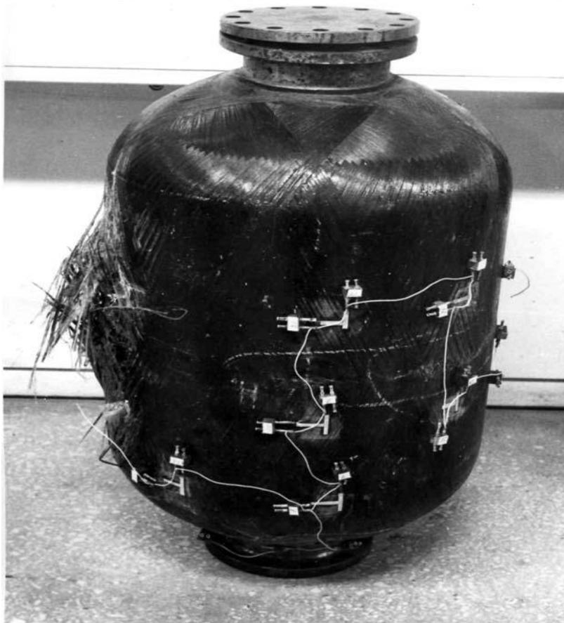
Рис. 5.12. Разрушение композитной оболочки при резонансном кумулятивном воздействии нагрузкой с  $I_{p1} = I_{p2} = 0,5 \text{ кПа} \times \text{с}$ ,  $\tau_{n1} = \tau_{n2} = 100 \text{ мкс}$ ,  $\tau_{скв} = 650 \text{ мкс}$
