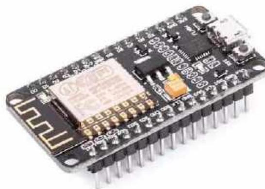
**Рисунок 7.10 – Плата *NodeMCU***
